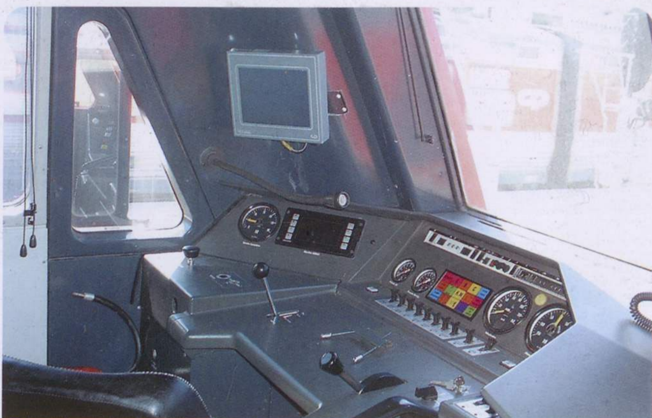
O maquinista visiona no monitor instalado na cabina o interior do comboio
