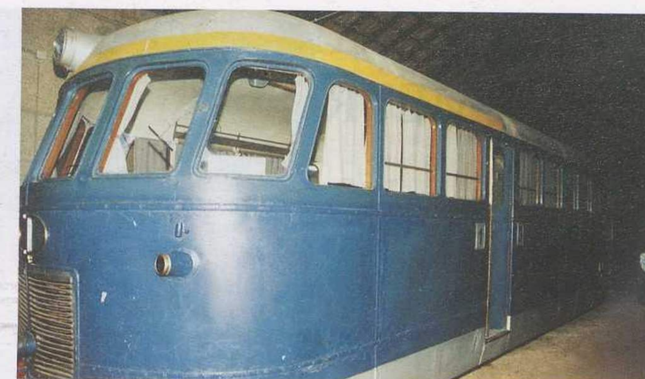
Uma automotora a gasolina, construída em Portugal. Os elevados custos com combustível obrigaram à sua substituição por automotoras movidas a diesel.
