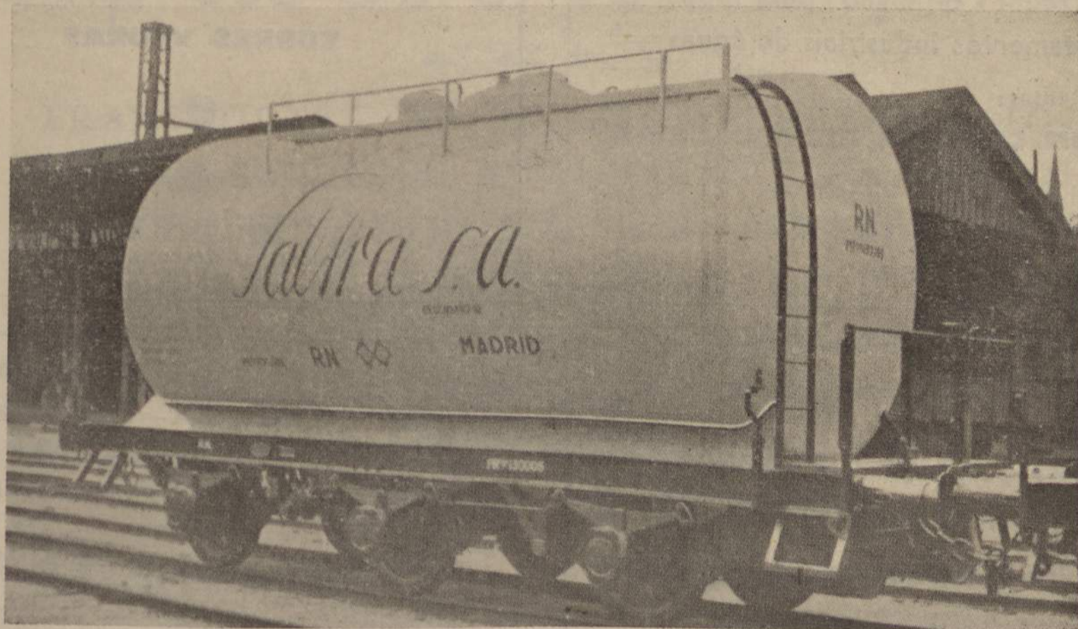
Vagón cisterna de grand capacidad (450 Hls), com bastidor aligerado, montado sobre tres ejes unificados tipo RN-20 y cajas de engrase ISOTHERMOS, con freno de husillo y vacío (dos cilindros) y equipo completo SAB, Construcción 1957.
