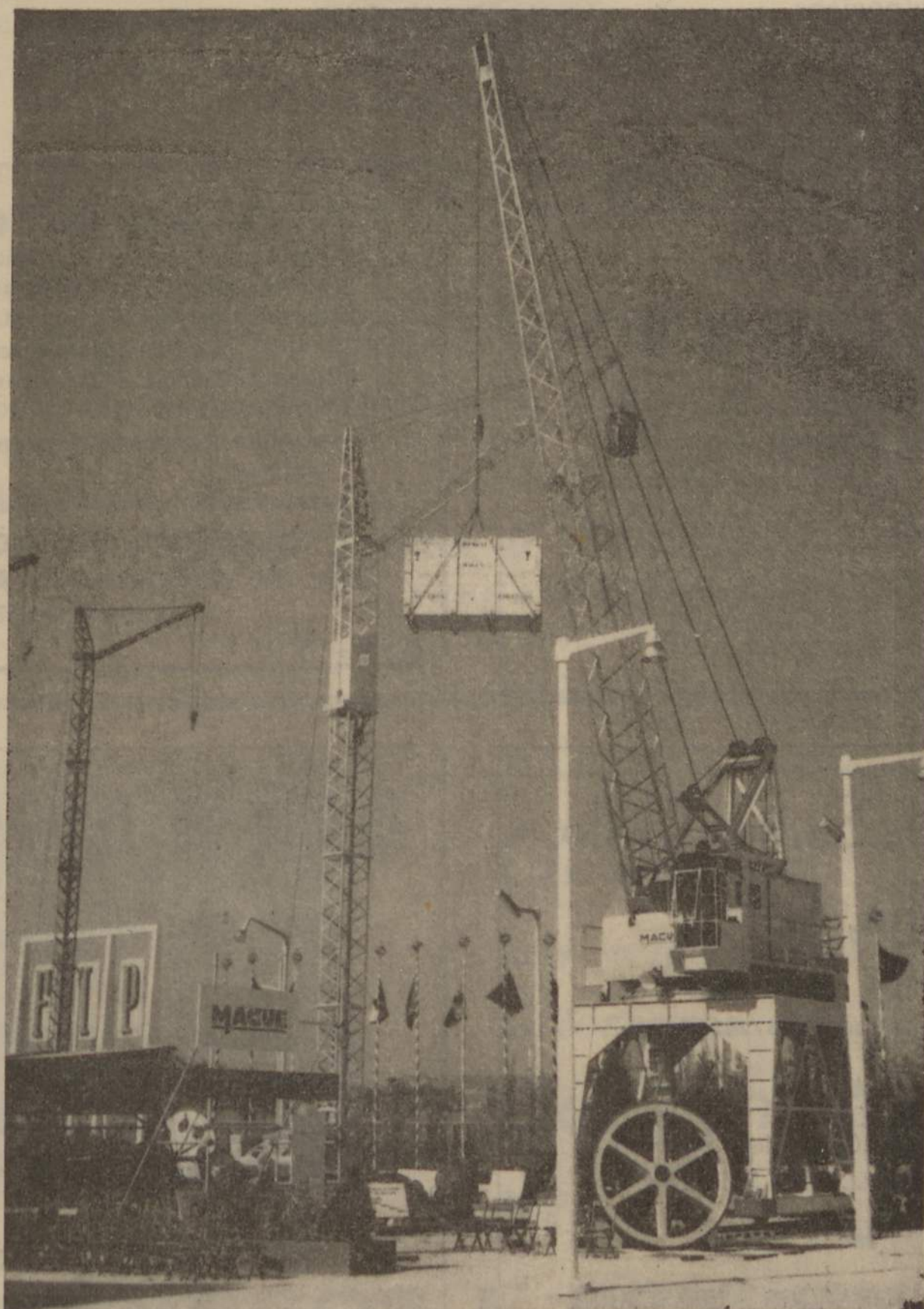
Guindastes portuários Diesel de 3 ton. a 14 m., destinados à ponte cais de Noqui em ANGOLA Aspecto de uma das unidades construídas, em exposição no stand da MAGUE na F. I. P. de 1957
