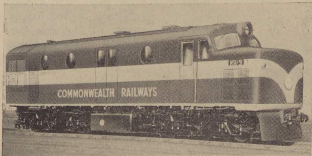
Locomotiva Diesel-eléctrica de 62 toneladas e meia de peso, que desenvolve a velocidade de 50 milhas por hora e se destina aos Caminhos de Ferro da Austrália (Commonwealth Railways)
