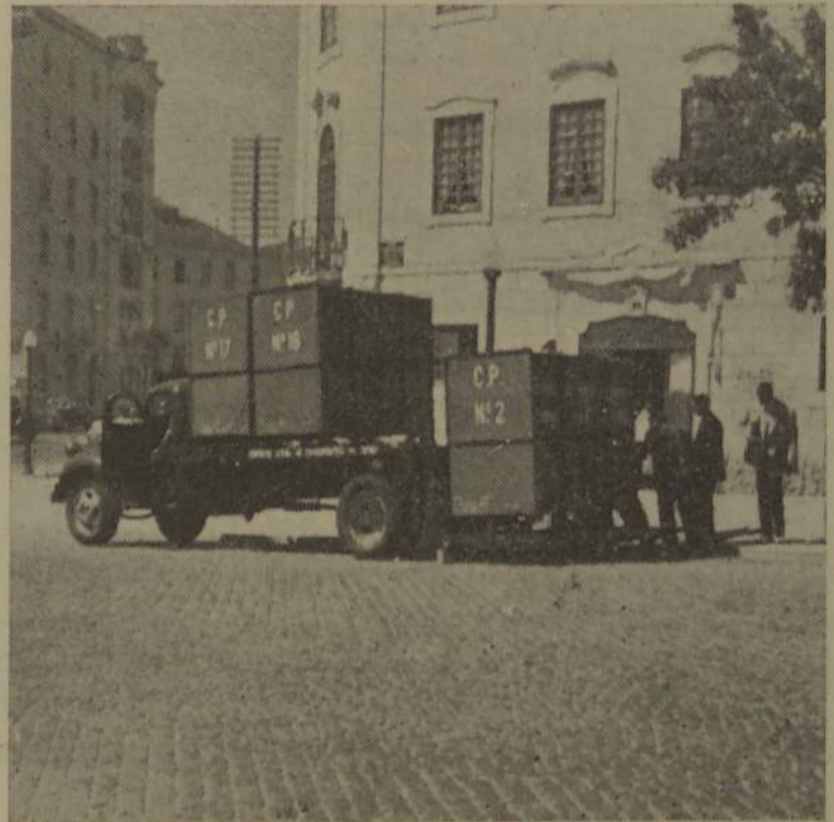
CAMIÃO MONTA-CARGAS PARA ELEVAR OS CONTENTORES
