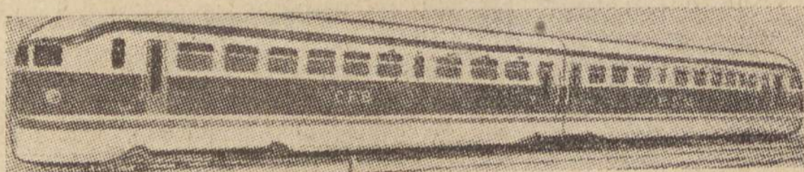
Formação automotora «Diesel Maybac» em serviço nos Caminhos de Ferro do Estado belga. Armações, motores e carrossagem, tudo é construído em duralumínio
