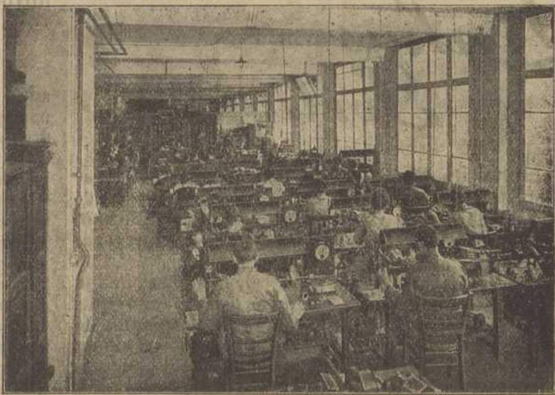
Fabricação dos espirais do fio luminoso para lampadas
