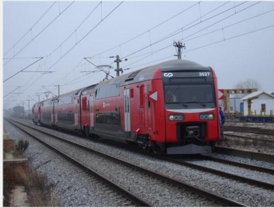
Ilustração 26 – Unidade de 2 pisos, que devolve energia à catenária por acção da frenagem.
